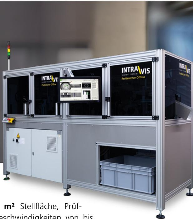
**3 m<sup>2</sup>** Stellfläche, Prüfgeschwindigkeiten von bis zu **100.000 Objekten pro Stunde, 17 Kameras** zur umfassenden Inspektion – das sind die Kernattribute des PreWatcher® Offline. Das Preforminspektionssystem bietet für Ihren Produktionsalltag viele Vorteile, wie schnelles Nachsortieren von gesperrten Octabins oder ein zügiger Wechsel auf andere Preformgrößen, der dank des neuartigen Einstellkonzeptes Zeit und damit Geld einspart. Denn: Wechselteile werden dabei nicht benötigt.
