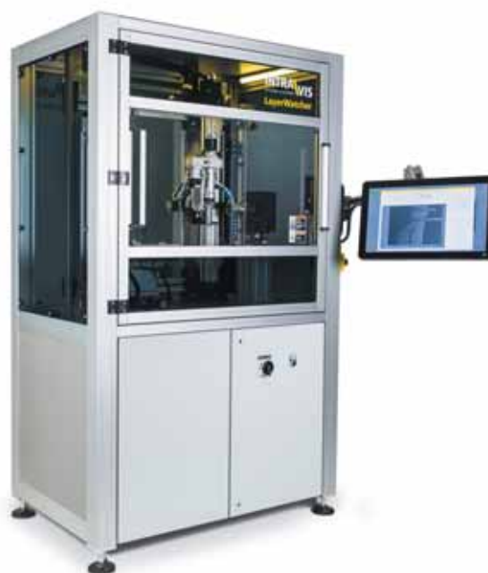
Фото 1. Система LayerWatcher неразрушающего ИК-контроля многослойных преформ занимает малую площадь и была разработана для применения в лабораторных условиях (все фото: Intravis)
