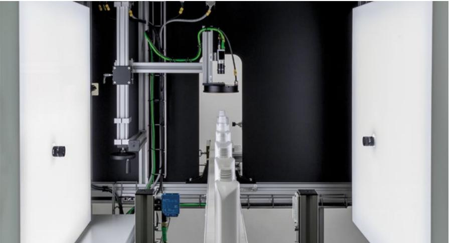
Inspektionssystem für alle grundlegenden Aufgaben der Qualitätskontrolle von Flaschen und Behältern
