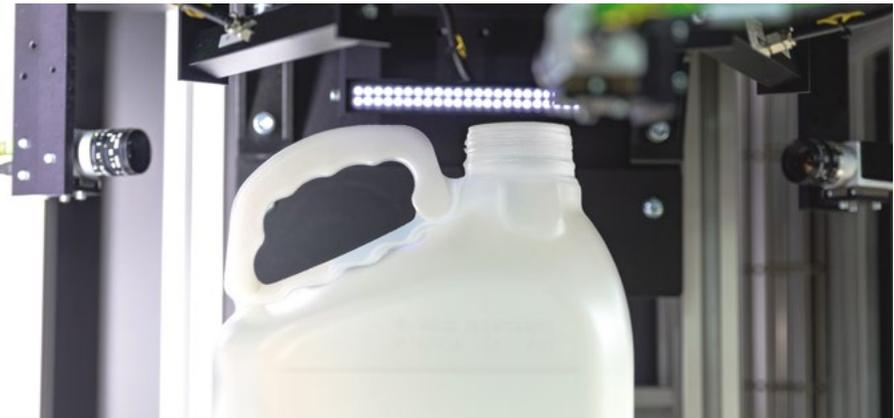
Maßgeschneidertes Bildverarbeitungssystem für eine umfassende Prüfung Ihrer Flaschen und Behälter
